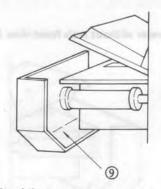
Fig. (d) Tape reader side view
