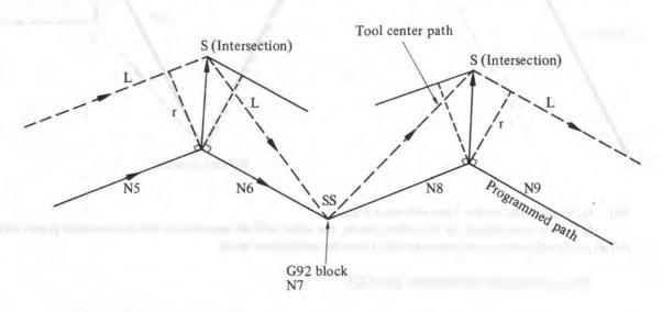
(G41 mode) N5 G01 X 3000 Y7000 ; N6 X-3000 Y6000 ; N7 G92 X 1000 Y2000 ; N8 G01 X 4000 Y8000 ;
